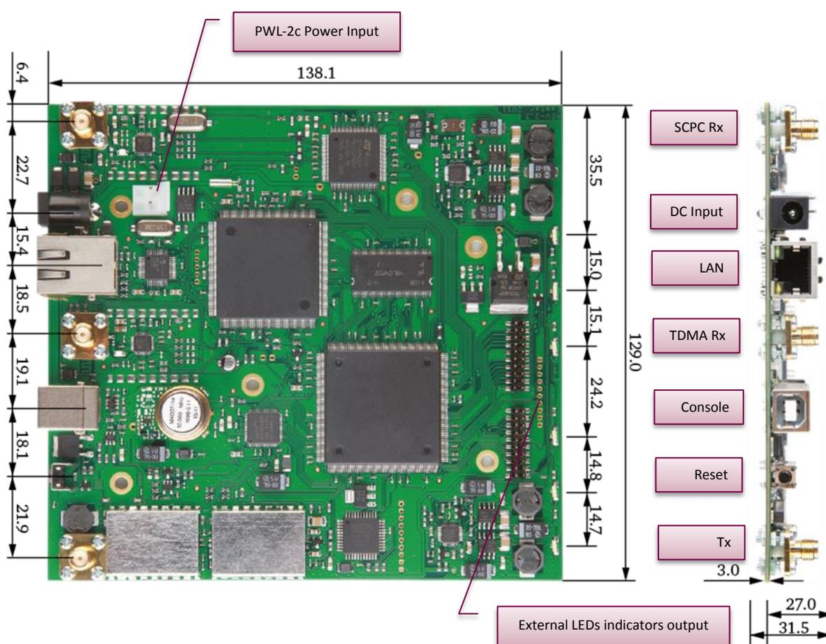
Рисунок 2 Внешний вид встраиваемого спутникового маршрутизатора UHP-1100
