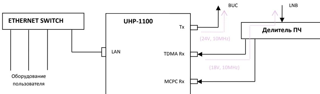
Рисунок 5 Пример подключения в режиме TDM/TDMA Mesh терминала
