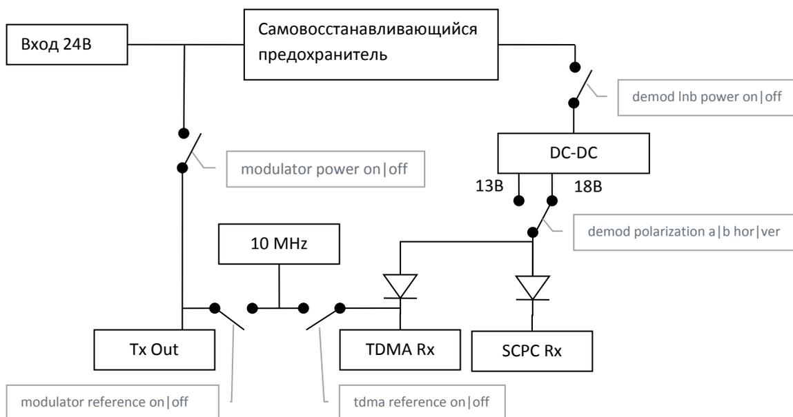
Рисунок 3 Управление питанием радиооборудования.
