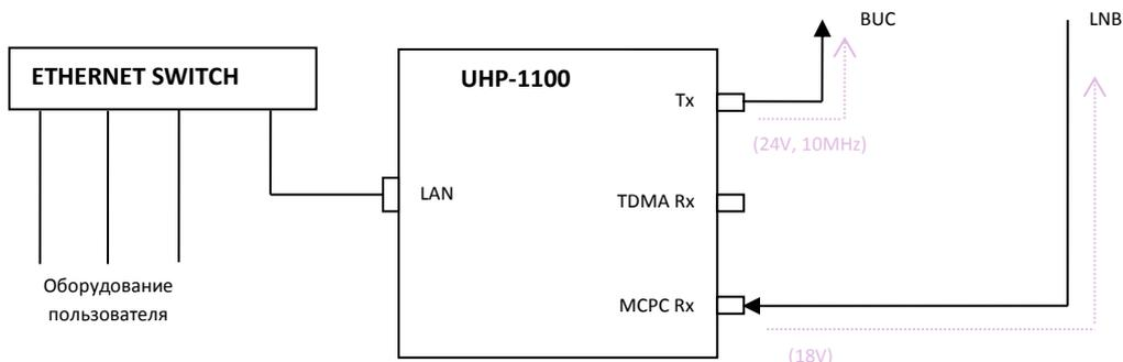
Рисунок 4 Пример подключения в режиме SCPC модема или TDM/TDMA терминала
